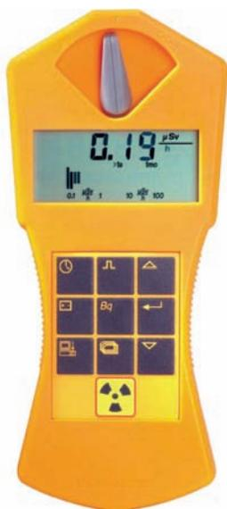
Il contatore Geiger commerciale GAMMA SCOUT misura anche le radiazioni alfa, essendo dotato di un'apposita finestra di mica.
