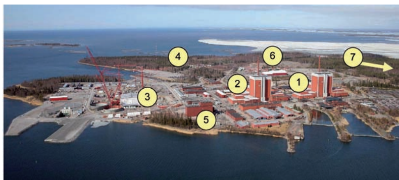
Figura 5: Il sito nucleare finlandese di Olkiluoto. Nell'ordine: 1) e 2) centrali nucleari OL1 e OL2, in funzione dagli anni '80; 3) centrale OL3 in costruzione (reattore EPR da 1600 MWe); 4) sito per il confinamento dei rifiuti a media e bassa attività, in deposito sotterraneo; 5) sito per il deposito temporaneo (sino al 2120) superficiale del combustibile esaurito; 6) sito per la possibile futura costruzione di OL4; 7) poco distante, ad Onkalo, si trova l'area dove sorgerà il sito geologico profondo (-500m) per lo stoccaggio definitivo del combustibile esaurito
